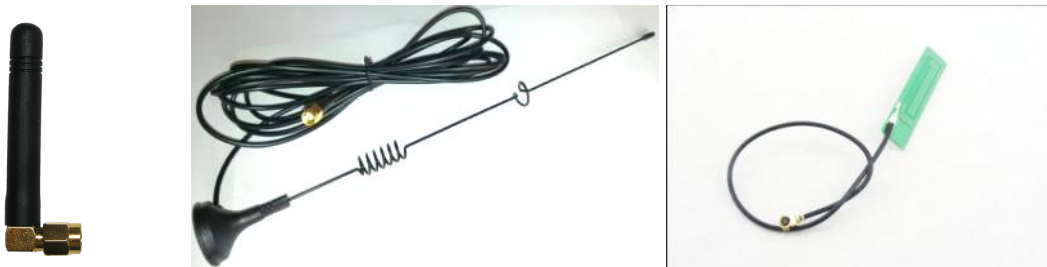
Imagen 6 Antenas GSM compatibles con la tarjeta MC60
