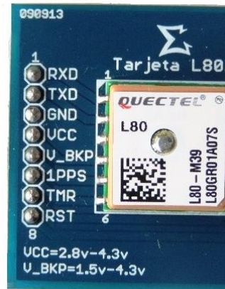
Figura 2: Pines de conexión
